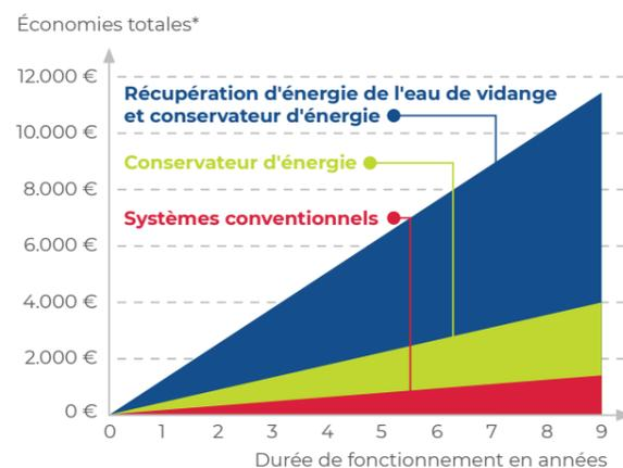
\* Base de calcul: Machine: AMXT avec 100 programmes de lavage par jour et 312 jours de travail par an; coût d'énergie: 0,23 € / kWh, Quantité de rinçage final: 2,0 l/casier
