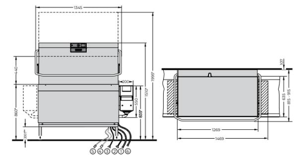
AMXXL et AUPL: hauteur du profil de la table de 40 mm max. pour une installation en angle.
