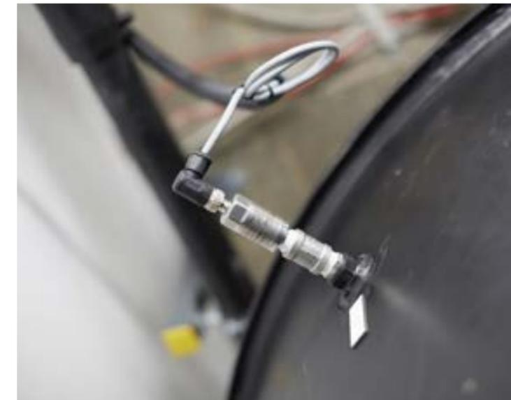
Le capteur intégré surveille le remplissage de la cuve
