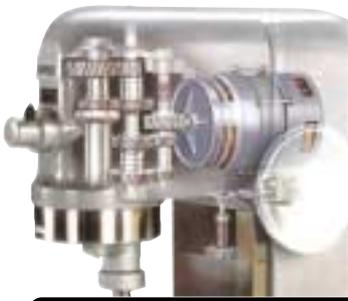
Grâce à une transmission directe par engrenage de la boîte de vitesse mécanique vers l'outil, les batteurs HOBART travaillent sans perte de puissance.
