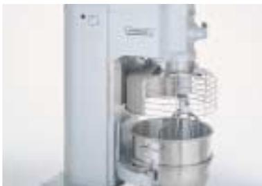
Les batteurs mélangeurs à grand volume sont munis d'un relevage de cuve par levier assisté et amorti grâce à un système de vérin ou un système de volant à crémaillère.
